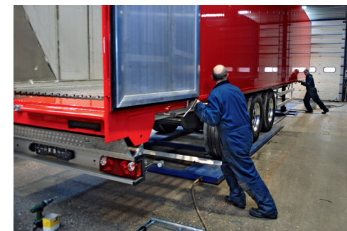
Hala montażu: pomyślowe poduszki umożliwiają przesuwanie naczepy w dowolnym kierunku
