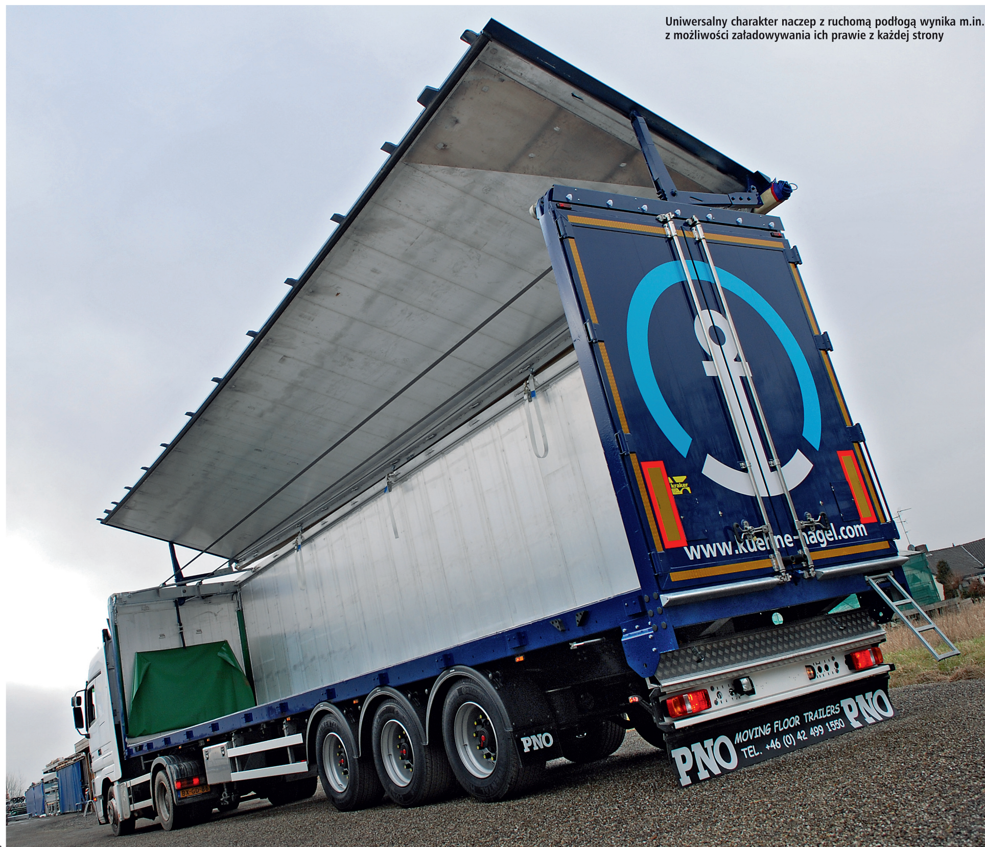
CF Steel Hybrid łączy lekkość konstrukcji z odpornością na ładunki takie jak złom, gruz, kamienie itp. Po roku testów naczepa trafi do klientów
