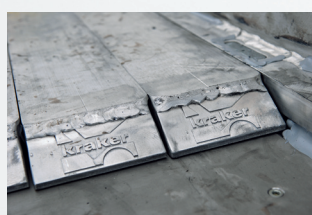
Ruchoma podłoga, czyli przesuwające się listwy podłogowe
